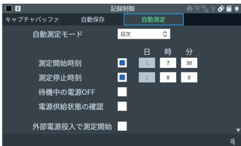
“測定開始時刻”、“測定停止時刻”には自動測定する期間を設定します。
