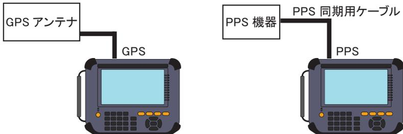
1 個の GPS アクティブアンテナで、2 台の LE-8500X のタイムスタンプを同期する場合は、次のように接続します。
