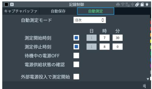
“測定開始時刻”、“測定停止時刻”には自動測定する期間を設定します。
