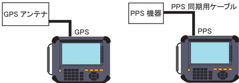
1 個の GPS アクティブアンテナで、2 台のタイムスタンプを同期する場合は、次のように接続します。
