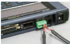
【RS-485の計測(端子台使用例)】
