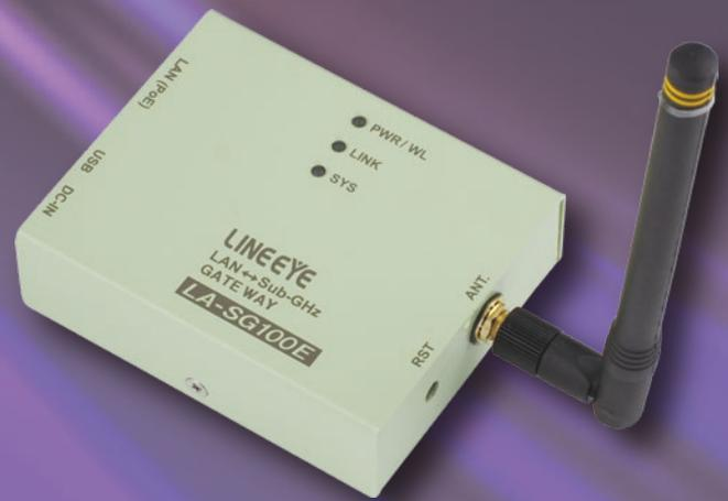
LANIO-SGシリーズはSUB-GHz(920MHz帯)無線経由で遠隔地の監視や制御信号のON/OFFを簡単に実現するIOユニットです。パソコンからゲートウェイ機「LA-SG100E」を介して遠隔地にあるLANIO-SGシリーズを制御監視したり、LANIO-SGシリーズを2台ペアで使用して相互に接点情報を無線伝送したりすることが可能です。SUB-GHz無線規格上の通信速度や転送休止時間などの制約を意識することなく運用でき、高速モードで見通し2km、長距離モードでは見通し7km先まで制御監視信号が伝送可能です。
