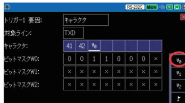
[ESC] でトリガー設定画面に戻り、対応するトリガー動作にタッチします。
