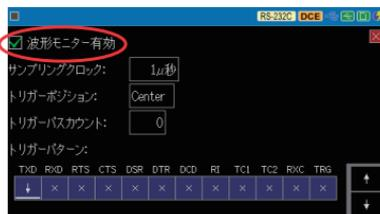
■ サンプリングクロックは通信速度の5 倍程度を目安に設定してください。
