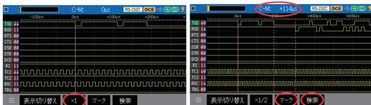
■ 赤の縦線がトリガー一点です。最初はトリガー一点にカーソル C (青点線) とマーカー M (赤点線) が重なっています。
