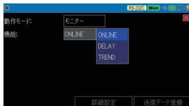
機能によっては“詳細設定”にタッチするか、[ENTER]を押して動作条件を設定します。
