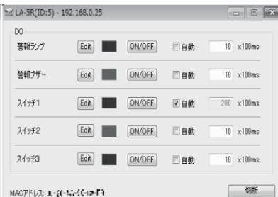
制御ウィンドウ上のボタンなどを操作して、出力状態の変更、入力状態の確認を行うことができます。制御ウィンドウ左側の四角形は入出力の状態を示し、OFF のときは灰色、ON のときは赤色になります。
