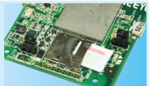
マイクロSIMコネクタをSIM交換がしやすい基板の表面に配置。NTTドコモ社および同社のMVNOが提供するLTE/3G対応のマイクロSIMカード対応。
